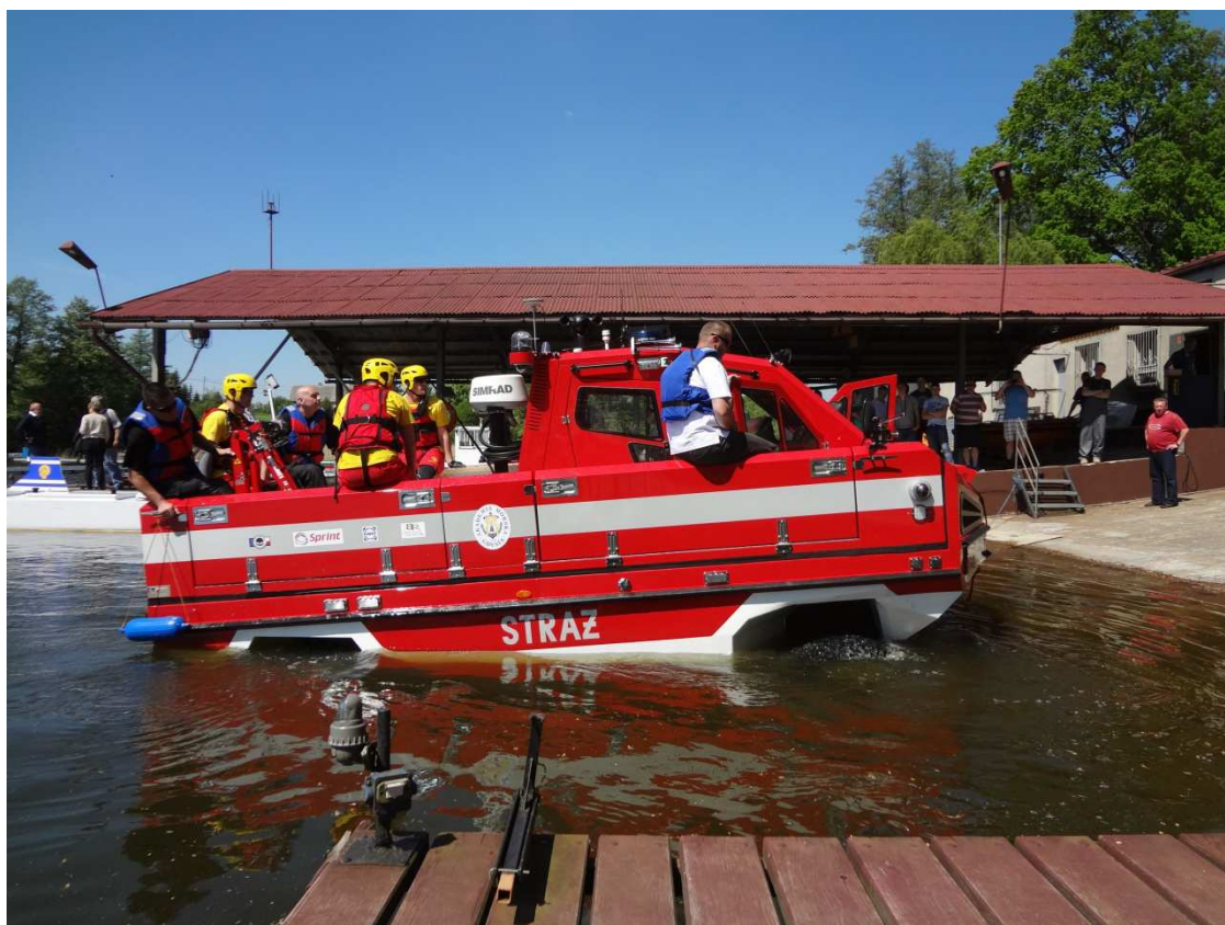
Amfibijny operacyjny pojazd ratowniczy (model II – Bukovina) podczas badań wodnych w Ośrodku Badawczo-Szkoleniowym Fundacji Bezpieczeństwa Żeglugi i Ochrony Środowiska na Jeziorze Silm w Iławie-Kamionce – wyjazd z wody
