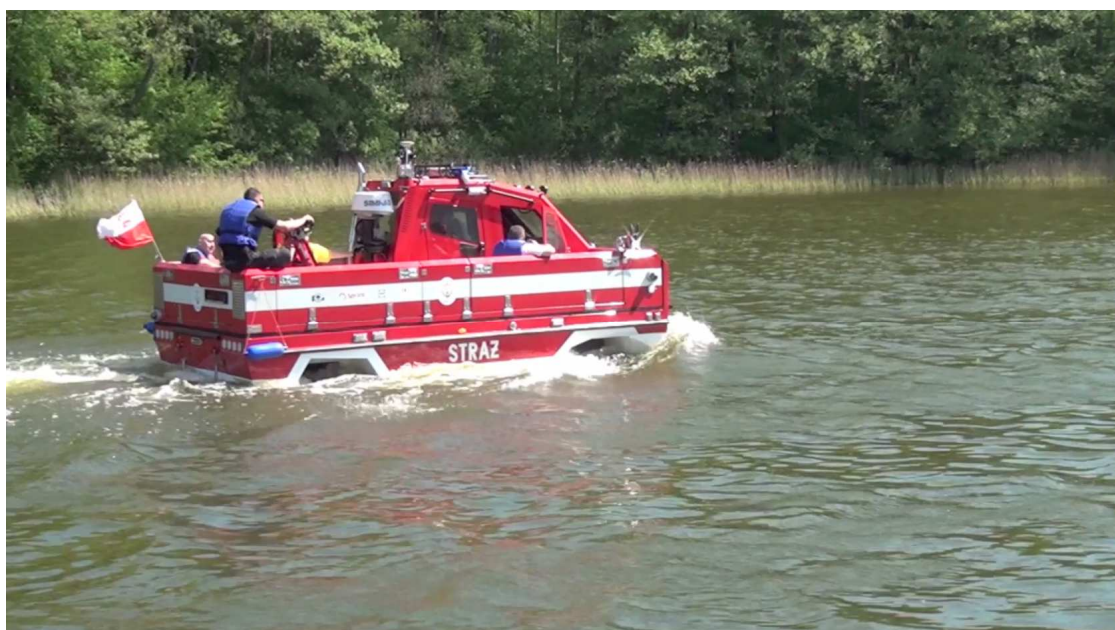
Amfibijny operacyjny pojazd ratowniczy (model II – Bukovina) podczas badań wodnych w Ośrodku Badawczo-Szkoleniowym Fundacji Bezpieczeństwa Żeglugi i Ochrony Środowiska na Jeziorze Silm w Iławie-Kamionce – próba prędkości
